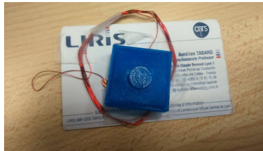
FIGURE 17 – Puce NFC avec un bouton poussoir
